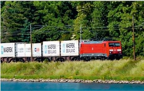
Die 32 Drehstrom-E-Lokomotiven der Baureihe 189 für den schweren Streckendienst können unter vier verschiedenen Spannungen betrieben werden. 2014 und 2015 wurden sie mit zusätzlichen Länderpaketen für den Einsatz in Polen und Tschechien ausgerüstet. Zu diesen Paketen gehören die jeweiligen Zugsicherungssysteme der Länder, neue oder angepasste Zugfunkanlagen, Feuerlöschanlagen für den Einsatz in Polen sowie die für Teile der Netze in Tschechien erforderlichen Störstromfilter.
