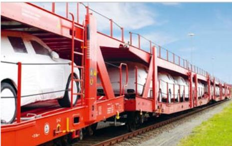
Die Doppelstockwaggons der Bauart Laaers 560.1 werden im internationalen Transport von Pkw, Geländewagen und Vans eingesetzt. Die hohe Lastgrenze ermöglicht den Transport von besonders schweren Fahrzeugen. Aufgrund der stufenlos verstellbaren oberen Ladeebene bietet die Bauart hohe Flexibilität beim Transport. So ist neben dem typenreinen Transport auch eine Mischverladung möglich. 2015 wurde die Flotte um 113 Laaers 560 auf 778 erweitert.
