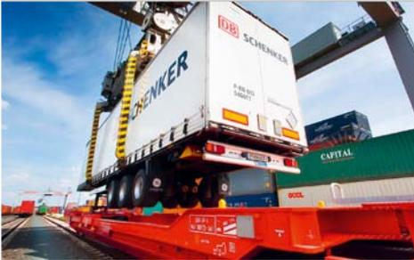
2015 hat DB Cargo weitere 259 Wagen der Baureihe Sdggmrs 738.1 beschafft. Die Doppeltaschenwagen können mit Sattelanhängern, Wechselbehältern und Containern beladen werden. Im Vergleich zum Vorgänger der Baureihe Sdggmrs 738 wird der Verschleiß an Radsätzen und Bremssohlen noch weiter reduziert. So kann ein wirtschaftlicherer Betrieb der Fahrzeuge sichergestellt werden.
