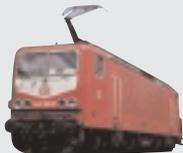
Die BR 143 ist die vielseitigste E-Lokomotive und neben der BR 111 sowie der BR 146 noch auf lange Sicht das „Zugpferd“ des Nahverkehrs. Durch die Ausrüstung mit verschiedenen Varianten der Wendezugsteuerung und weiteren nahverkehrsspezifischen Einrichtungen sind diese Lokomotiven vor den meisten Wendezügen des Nahverkehrs anzutreffen.
