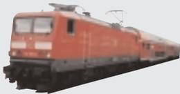
Die Baureihe (BR) 112 ist eine Weiterentwicklung der bewährten BR 143/114, die bei der Deutschen Reichsbahn im Einsatz war. Als vierachsige Lokomotive mit einer Höchstgeschwindigkeit von 160 km/h ist sie für den schnellen Regionalverkehr geeignet und kann aufgrund ihrer Wendezugfähigkeit mit Steuerwagen betrieben werden. Die 90 Lokomotiven der BR 112 gehören seit dem 1. Januar 2004 zur DB Regio AG (vorher DB Fernverkehr AG).
