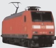
Die BR 146.0 und 146.1/146.2 stellen eine Weiterentwicklung der für Railion entwickelten BR 145 und 185.1/185.2 dar. Durch den Einbau neu entwickelter Drehgestelle sind Geschwindigkeiten bis 160 km/h möglich. Für den Einsatz im Nahverkehr wurde die Lok mit Wendezugsteuerung, seitenselektiver Türsteuerung und einem Fahrgast-Informationssystem ausgestattet. Die 53 Lokomotiven werden bisher in Rheinland-Pfalz, Nordrhein-Westfalen, Niedersachsen, Hessen und Baden-Württemberg eingesetzt.
